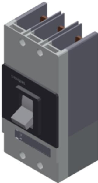
Leitungsschalter VL400X UL; Typ LG (CAT NO. NLK3R400) non-interchangeable frame, mit Approbation Circuit-Breaker nach UL 489 Standardschaltvermögen 3-polig, NEMA Rating 35kA/480V and 18kA/600V (molded case circuit breaker) Überstromauslöser ETU, LI TU=40°C In=400A, Bemessungsstrom II=1,25 bis 11 xIN, Kurzschlusschutz IR=150-400A Überstromauslöser für Anlagenschutz ohne Anschlusszubehör
