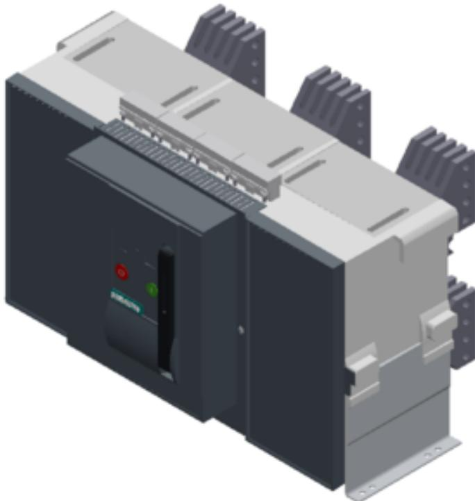
Festeinbau-Leistungstrennschalter 3-polig, Baugröße 3, IEC In=5000A bis 690V, AC 50/60Hz Icu=100kA bei 500V Anschluss rückseitig vertikal
