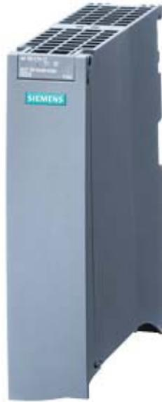
SIMATIC ET 200MP. PROFINET IO-Device Interface-Modul IM 155-5 PN HF, für ET 200MP Elektronikmodule; bis zu 12 IO-Module ohne PS; bis zu 30 IO-Module mit zusätzlicher PS; integrierter 2PORT-Switch; RJ45 Shared Device; MRP; IRT  $\geq 0,25\text{ms}$ ; Taktsynchronität FW-Update; I&M0...3; priorisierter Hochlauf, S2-Redundanz; Shared Device mit 4 Controllern
