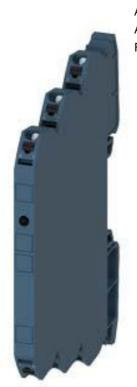
Ausgangskoppler Relaiskoppler, 1 W, DC 24 V Arbeitsbereich 0,7...1,25 x US Gehäusebreite 6,2 mm Federzuganschluss (Push-In) thermischer Strom 6A
