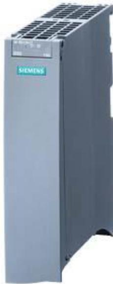
SIPLUS ET 200MP IM 155-5 PN ST -40...+70°C mit conformal coating based on 6ES7155-5AA00-0AB0 . PROFINET IO-Device Interface-Modul IM 155-5 PN ST "für ET 200MP Elektronikmodule; "bis zu 12 IO-Module ohne PS;" bis zu 30 IO-Module mit "zusätzlicher PS;" "integrierter 2PORT-Switch; RJ4 "Shared Device; MRP;" "IRT >=0,25ms; Taktsynchronität "FW-Update; I< (>&<) >M0...3;" FSU mit 500ms
