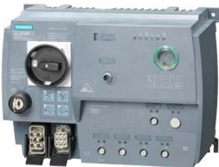
SIRIUS Motorstarter M200D AS-i Kommunikation: AS-Interface Reversierstarter Basic mechanisch schaltend AC-3, 5,5 kW / 400 V 1,5 A...12,00 A elektronischer Überlastschutz Thermistor: THERMOCLICK / PTC mit Bremskontakt 400 V AC 2DI AS-i + 2DI / 1DO am Gerät Han Q4/2 - Han Q8/0 mit Hand-vor-Ort Bedienung und Schlüsselschalter
