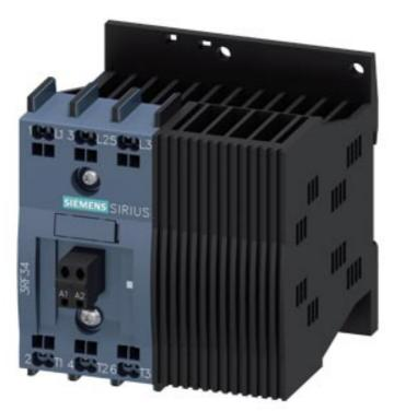
Halbleiterschütz 3-phasig 3RF3 AC 53 / 16 A / 40 °C 48-600 V / DC 24 V 2-Phasengesteuert momentanschaltend Federzuganschluss
