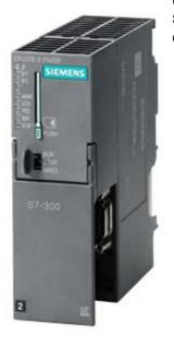
SIPLUS S7-300 CPU 315F-2PN/DP -25...+60°C mit conformal coating based on 6ES7315-2FJ14-0AB0 . Zentralbaugruppe mit 512 KByte Arbeitsspeicher, 1. Schnittstelle MPI/DP 12MBit/ s, 2. Schnittstelle Ethernet PROFINET, mit 2 Port Switch, Micro Memory Card erforderlich
