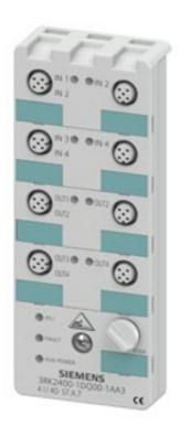
AS-i Kompaktmodul K60 digital A/B-Slave, 4DI/4DQ, IP67 4 x Eingang, maximal 1000 mA Sensorversorgung aus DC 24 V 4 x Ausgang, 2 A, DC 24 V maximal 4 A für alle Ausgänge 8 x M12-Buchse Y-II-Belegung Montageplatte 3RK1901-0CA00 ist separat zu bestellen
