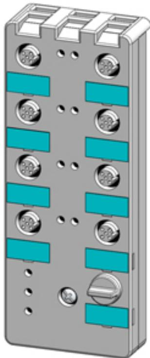
AS-i Kompaktmodul K60 digital A/B-Slave, 8DI, IP 67 8 x Eingang, maximal 2000 mA Sensorversorgung aus DC 24 V 8 x M12-Buchse Y-II-Belegung Montageplatte 3RK1901-0CA00 ist separat zu bestellen
