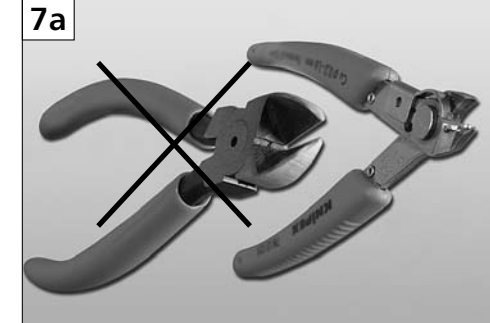
Zum Entfernen der überstehenden Adern einen geeigneten Seitenschneider verwenden ... Use an appropriate wire cutter to cut the excess length of the wires ...
