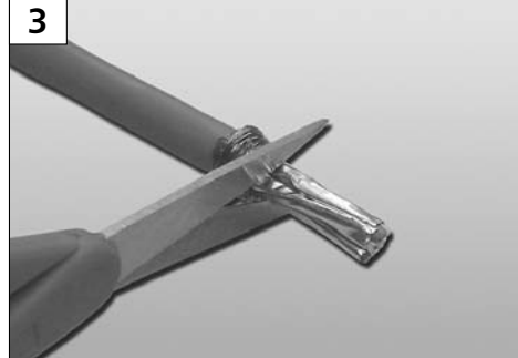
Paar-Schirmfolie einkerben und entfernen. Cut and remove the shield foil of the wire pairs.
