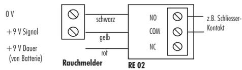
2. Zur Umwandlung eines DC Signals (z.B. 12 V Alarmausgang) in einen potentialfreien Ausgang
