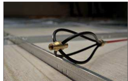
Der Gleitauflauf erleichtert das Führen von Kabeln und Leitungen über raue und unebene Oberflächen.
