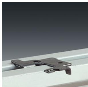
Deckenbefestigung für DUS, aus Stahlblech, verzinkt, Tragkraft 20 kg
