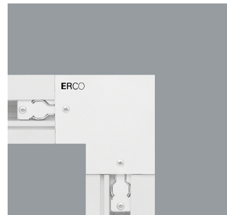
79344.000 3-Phasen-Eckverbinder Weiß Kunststoff. Schutzleiter innen. Einspeisung möglich. Durchverdrahtung.
