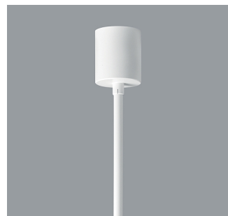
12446.000 Pendelrohrabhangung Weiß Pendelrohr: Metall, pulverbeschichtet. \varnothing 13mm, L 1040mm. Baldachin: Kunststoff. \varnothing 64mm, H 73mm. Belastung 20kg. 日本 Nur in Verbindung mit: 78671.000 79551.000 79556.000 79561.000 79566.000 79571.000
