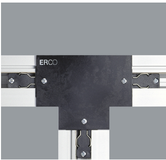
79367.000 3-Phasen-T-Verbinder Schwarz Kunststoff. Schutzleiter links. Einspeisung möglich. Durchverdrahtung. ☑️ ☑️
