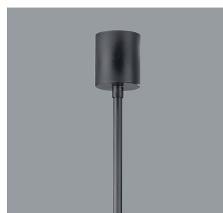
12445.000 Pendelrohrabhangung Schwarz Pendelrohr: Metall, pulverbeschichtet. \varnothing 13mm, L 1040mm. Baldachin: Kunststoff. \varnothing 64mm, H 73mm. Belastung 20kg. 日本 Nur in Verbindung mit: 78670.000 79550.000 79555.000 79560.000 79565.000 79570.000
