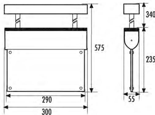
Einzelbatterie-Notleuchten Serie SLC, SLD, SLE, SLF und SLG mit Fail-Safe-Kontakt
