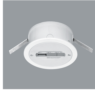
79094.000 DALI Punktauslass Weiß Einbaumontage/Betoneinbau. Für Strahler mit ERCO DALI Adapter, 250V, 6A. Kunststoff. Zugentlastung. Mechanische Belastung: Deckenmontage 8,00kg. Wandmontage 3,50kg. Gewicht 0,32kg
