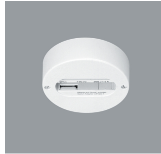
79092.000 DALI Punktauslass Weiß Aufbaumontage. Für Strahler mit ERCO DALI Adapter, 250V, 6A. Kunststoff. Zugentlastung. Mechanische Belastung: Deckenmontage 8,00kg. Wandmontage 3,50kg. Gewicht 0,13kg
