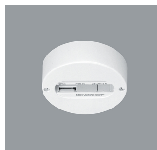
79039.000 1-Phasen-Punktauslass Weiß Aufbaumontage. Für Strahler mit ERCO 3-Phasen-Adapter, 250V, 6A. Kunststoff. Zugentlastung. Mechanische Belastung: Deckenmontage 8,00kg. Wandmontage 3,50kg. Gewicht 0,12kg 🇯🇵 🇩🇪
