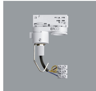
79055.000 ERCO 3-Phasen-Adapter Weiß Für Pendelleuchte, 250V, 10A, mit Befestigungshaken und Anschlussklemme. Kunststoff. Belastung 10kg. L 71mm, B 32mm, H 33mm. 🇯🇵
