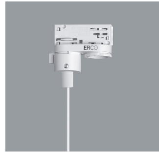
79031.000 ERCO 3-Phasen-Adapter Weiß Bausatz für Pendelleuchte, 250V, 10A, mit Zugentlastung. Kunststoff. Anschlussleitung 3x0,75mm 2 , L 1500mm. Belastung 3,30kg. Montage der Einzelteile muss bauseits erfolgen. Gewicht 0,15kg 🇯🇵
