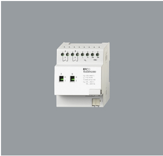
83816.000 DALI Schaltaktor 2fach, 16A 2 potentialfreie Kontakte zum Schalten von ohmschen, induktiven und kapazitiven Lasten bis max. 16A. DALI Schnittstelle mit 2 unabhängigen Adressen. Montage auf Hutprofilschiene. Gewicht 0,21kg
