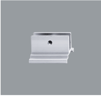
79504.000 Stoßstellenverbinder Mit zwei Schrauben. Aluminium, eloxiert. Belastung 30kg. L 50mm, H 26mm. 日本
