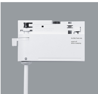
79047.000 ERCO DALI Adapter Weiß Für Pendelleuchte, 250V, 1A, mit Zugentlastung. Kunststoff. Anschlussleitung 5x0,75mm 2 , L 1500mm. Anforderung an DALI Betriebsgerät: DALI Eingang geeignet für Netzspannung, Kapazität max. 750pF. Nicht für DALI Punktauslass geeignet. Gewicht 0,39kg
