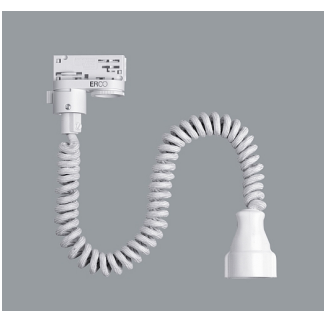
79053.000 ERCO 3-Phasen-Adapter Weiß Mit Schukokupplung. 250V, 6A. Wendelleitung 3x0,75mm 2 . L 700/1400mm.
