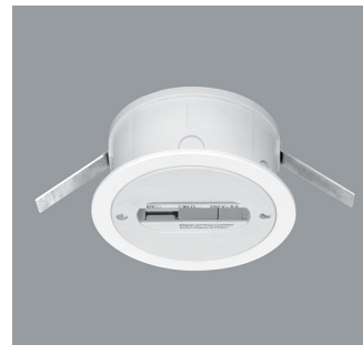
79037.000 1-Phasen-Punktauslass Weiß Einbaumontage/Betoneinbau. Für Strahler mit ERCO 3-Phasen-Adapter, 250V, 6A. Kunststoff. Zugentlastung. Mechanische Belastung: Deckenmontage 8,00kg. Wandmontage 3,50kg. Gewicht 0,32kg 🇯🇵 🇩🇪
