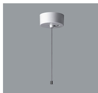
12671.000 Drahtseilabhangung Drahtseil: \varnothing 1,50mm, L 2500mm. Befestigungshulse: Metall. Baldachin: Kunststoff, wei. \varnothing 105mm, H 43mm. Leitungseinfuhrung fur 5x1,5mm 2 Mantelleitung oder Wendelleitung. Zugentlastung. Anschlussklemme. Belastung 20kg. 日本 Nur in Verbindung mit: 78671.000 79551.000 79556.000 79561.000 79566.000 79571.000
