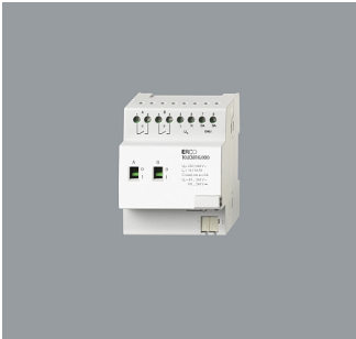
83816.000 DALI Schaltaktor 2fach, 16A 2 potentialfreie Kontakte zum Schalten von ohmschen, induktiven und kapazitiven Lasten bis max. 16A. DALI Schnittstelle mit 2 unabhängigen Adressen. Montage auf Hutprofilsschiene. Gewicht 0,21kg
