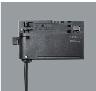
79048.000 ERCO DALI Adapter Schwarz Für Pendelleuchte, 250V, 1A, mit Zugentlastung. Kunststoff. Anschlussleitung 5x0,75mm 2 , L 1500mm. Anforderung an DALI Betriebsgerät: DALI Eingang geeignet für Netzspannung, Kapazität max. 750pF. Nicht für DALI Punktauslass geeignet. Gewicht 0,39kg
