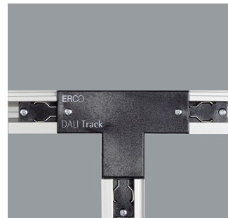
79228.000 DALI T-Verbinder Schwarz Kunststoff. Schutzleiter rechts. Einspeisung möglich. Durchverdrahtung.
