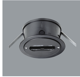
79095.000 DALI Punktauslass Schwarz Einbaumontage/Betoneinbau. Für Strahler mit ERCO DALI Adapter, 250V, 6A. Kunststoff. Zugentlastung. Mechanische Belastung: Deckenmontage 8,00kg. Wandmontage 3,50kg. Gewicht 0,32kg
