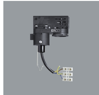
79054.000 ERCO 3-Phasen-Adapter Schwarz Für Pendelleuchte, 250V, 10A, mit Befestigungshaken und Anschlussklemme. Kunststoff. Belastung 10kg. L 71mm, B 32mm, H 33mm. Japan
