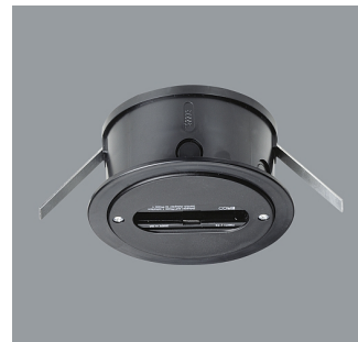
79036.000 1-Phasen-Punktauslass Schwarz Einbaumontage/Betoneinbau. Für Strahler mit ERCO 3-Phasen-Adapter, 250V, 6A. Kunststoff. Zugentlastung. Mechanische Belastung: Deckenmontage 8,00kg. Wandmontage 3,50kg. Gewicht 0,32kg Japan
