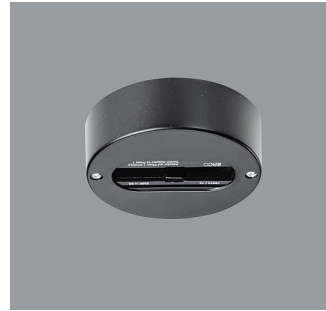
79093.000 DALI Punktauslass Schwarz Aufbaumontage. Für Strahler mit ERCO DALI Adapter, 250V, 6A. Kunststoff. Zugentlastung. Mechanische Belastung: Deckenmontage 8,00kg. Wandmontage 3,50kg. Gewicht 0,13kg
