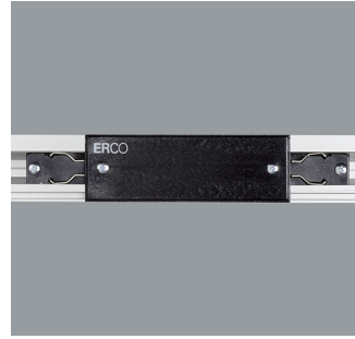
79324.000 3-Phasen-Kupplung Schwarz Kunststoff. Einspeisung möglich. Durchverdrahtung. 日本
