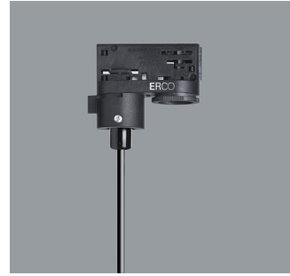
79030.000 ERCO 3-Phasen-Adapter Schwarz Bausatz für Pendelleuchte, 250V, 10A, mit Zugentlastung. Kunststoff. Anschlussleitung 3x0,75mm 2 , L 1500mm. Belastung 3,30kg. Montage der Einzelteile muss bauseits erfolgen. Gewicht 0,15kg 🇯🇵
