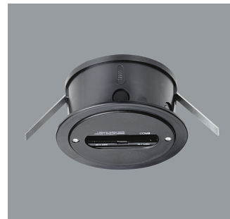
79036.000 1-Phasen-Punktauslass Schwarz Einbaumontage/Betoneinbau. Für Strahler mit ERCO 3-Phasen-Adapter, 250V, 6A. Kunststoff. Zugentlastung. Mechanische Belastung: Deckenmontage 8,00kg. Wandmontage 3,50kg. Gewicht 0,32kg 🇯🇵 🇩🇪
