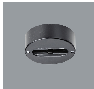
79038.000 1-Phasen-Punktauslass Schwarz Aufbaumontage. Für Strahler mit ERCO 3-Phasen-Adapter, 250V, 6A. Kunststoff. Zugentlastung. Mechanische Belastung: Deckenmontage 8,00kg. Wandmontage 3,50kg. Gewicht 0,12kg 🇯🇵 🇩🇪
