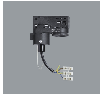
79054.000 ERCO 3-Phasen-Adapter Schwarz Für Pendelleuchte, 250V, 10A, mit Befestigungshaken und Anschlussklemme. Kunststoff. Belastung 10kg. L 71mm, B 32mm, H 33mm. 🇯🇵
