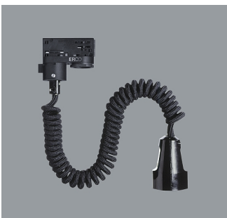
79052.000 ERCO 3-Phasen-Adapter Schwarz Mit Schukokupplung. 250V, 6A. Wendelleitung 3x0,75mm 2 . L 700/1400mm.
