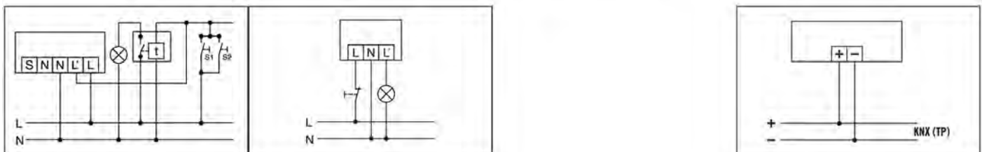
Parallelschaltung mit Treppenlichtautomat
