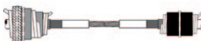
2) Isolierkörper, Außenschläuche und Kupfergewebeschauch auf dem Kabel parken
