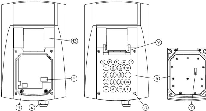
Flachbandkabel mit Steckverbinder auf die Stiftleiste (7) der Tastaturplatte stecken.
