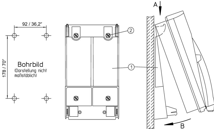
Hängen Sie das Telefon in die oberen Rasthaken ein (A), schwenken es nach unten bis die unteren Rasthaken hörbar einrasten (B).
