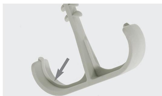
*Mit der USD werden gleich zwei Rohre montiert – ohne zu gipsen, mit nur einem Bohrloch. Und durch die integrierte Nase an der Innenseite der Schelle kann man den Schlauch für einen leichteren Kabeleinzug spannen.*
