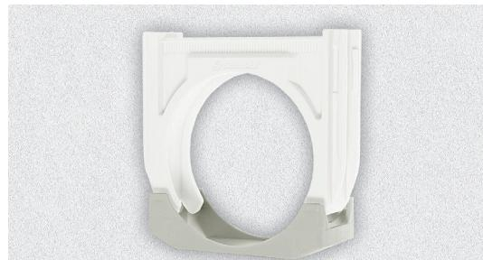
Der EC Euro-Clip in Verbindung mit dem UVB Universal-Verschlussbügel erfüllt die Anforderungen an eine geschlossene Schelle um z. B. bei Montage von Rohren in hoher Umgebungs-Temperatur (Verformung) das Herausrutschen zu verhindern.
