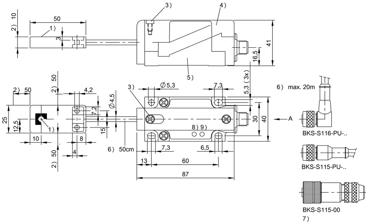
1) aktive Fläche, 2) Freizone, 3) Arretierschraube, 4) Moduleinheit, 5) Montagesockel, 6) Kabellänge, 7) ohne Kabel, 8) Power, 9) Tag present
