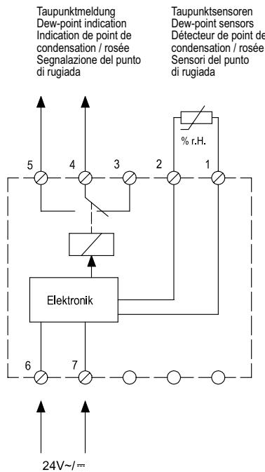
**Maßbilder / Dimensioned Drawings / Schéma de connexion / Schema di allacciamento**
