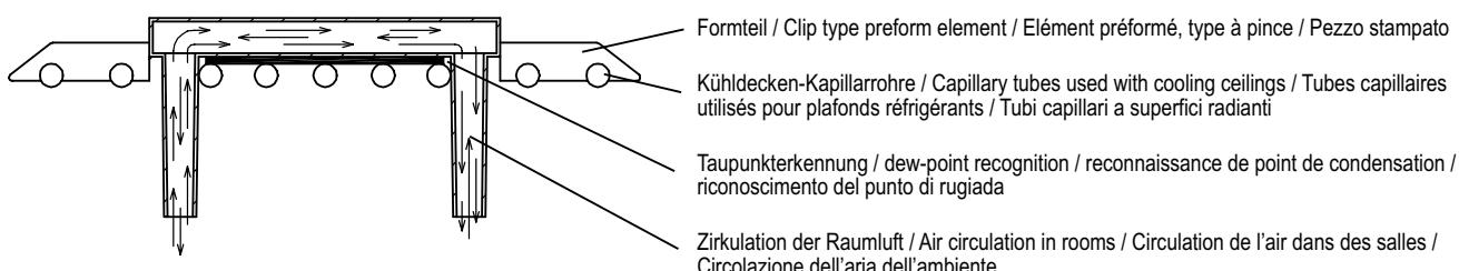
**Typ TPS 2:** Zur Montage am Rohr, befestigt mit Spannband, Zuluftkanäle führen auf der dem Rohr abgewendeten Seite durch den Putz in den zu kühlenden Raum, z.B. Hinterwandmontage.
