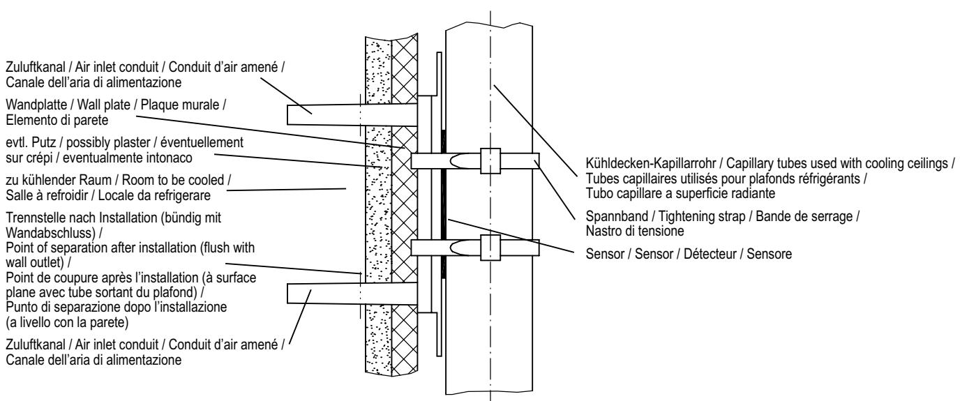
**Typ TPS 1:** Zur Montage auf der Kühlmatte aufliegend, befestigt mit Spannband oder beiliegendem Formteil, Zuluftkanäle tauchen durch die Kühlmatte hindurch, z.B. Kassettendecke, Trockenbaudecke.
