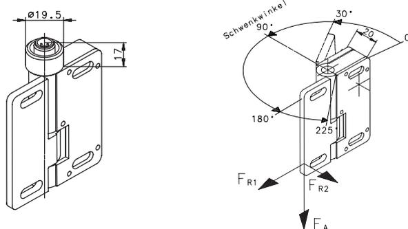
Darstellung mit fixierter Welle und abgescherter Abrisschraube.
