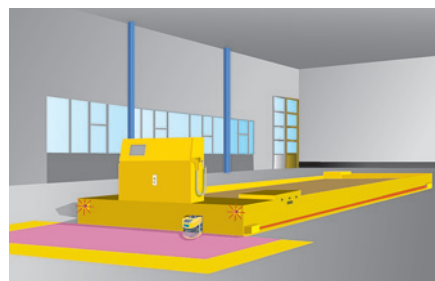
Seitliche Absicherung an einem fahrerlosen Transportfahrzeug
