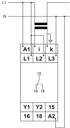
Anschluss 1~ 230V mit Powermodul 230V AC ohne Fehlerspeicher
