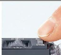
Durch Drücken der Mode-Taste springt man innerhalb des PRO-Modus um eine Ebene nach oben (im Diagramm also nach links) bzw. bricht den momentanen Einstellvorgang ab („ESC“-Taste). Im Hauptmenü schaltet man zur nächsten Funktion.
