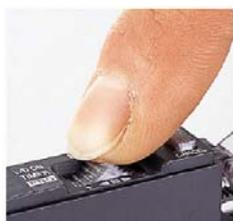
Durch Drücken des Jog-Dial-Taste wird der Wert bestätigt bzw. man gelangt in die weiterführende Unterfunktion (Navigation nach rechts).
