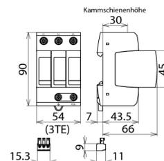
3-poliger modularer Überspannungs-Ableiter für Windenergieanlagen mit Varistor-Bemessungsspannung  $U_{mov} = 750 \text{ V AC}$ ; in der Ausführung FM mit potentialfreiem Fernmeldekontakt
