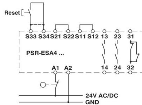
Einkanalige Schutztürüberwachung mit automatischer Aktivierung, geeignet bis Sicherheitskategorie 2.
