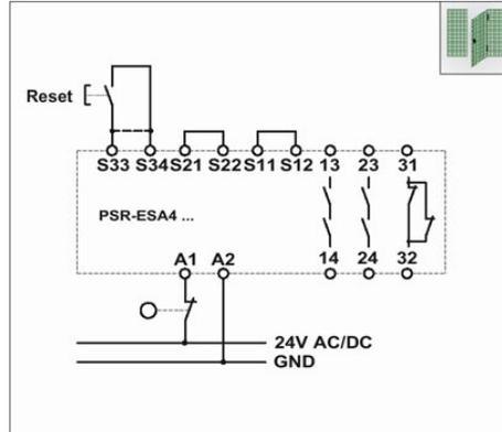
Einkanalige Schutztürüberwachung mit automatischer Aktivierung, geeignet bis Sicherheitskategorie 2.
