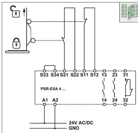
Zweikanalige Schutztür-Überwachung mit Querschlußüberwachung und automatischer Aktivierung, geeignet bis Sicherheitskategorie 4.
