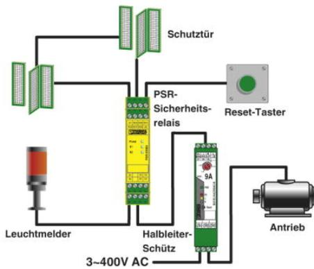
Beispiel einer Schutztür-Applikation mit einem PSR-Sicherheitsrelais PSR-ESM4.
