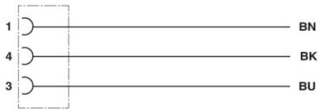
Kontaktbelegung der M8-Buchse
