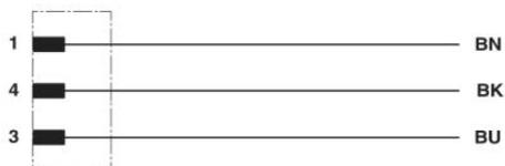
Kontaktbelegung des M12-Steckers
