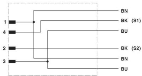
Kontaktbelegung des M12 Y-Steckverbinders
