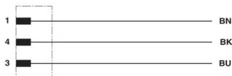
Kontaktbelegung des M8 Steckers
