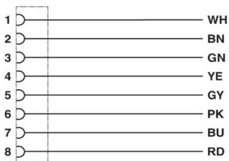
Kontaktbelegung der M12-Buchse
