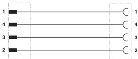
Kontaktbelegung des M12-Stecker und der M12-Buchse
