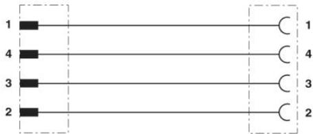
Kontaktbelegung des M12-Stecker und der M12-Buchse
