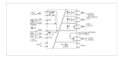
Mit dem Drehzahlwächter IM21-14-CDTRI werden Frequenzen, Drehzahlen und Impulsfolgen, beispielsweise von rotierenden Teilen an Motoren, Getrieben und Turbinen, ausgewertet und auf Über- bzw. Unterschreitung eingestellter Grenzwerte überwacht. Ein Display in der Gerätefront zeigt den aktuellen Wert an.
