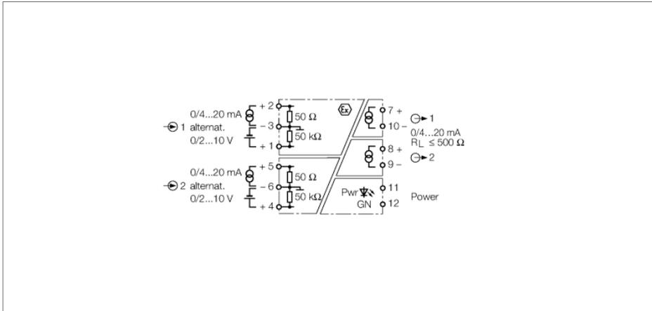
Über den zweikanaligen Analogsignaltrenner IM31-22EX-I werden normierte, aktive Spannungs- oder Stromsignale galvanisch getrennt aus dem Ex-Bereich in den Nicht-Ex-Bereich übertragen.
