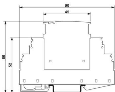
Abbildung zeigt das Kompletต์modul, bestehend aus Basiselement und Stecker
